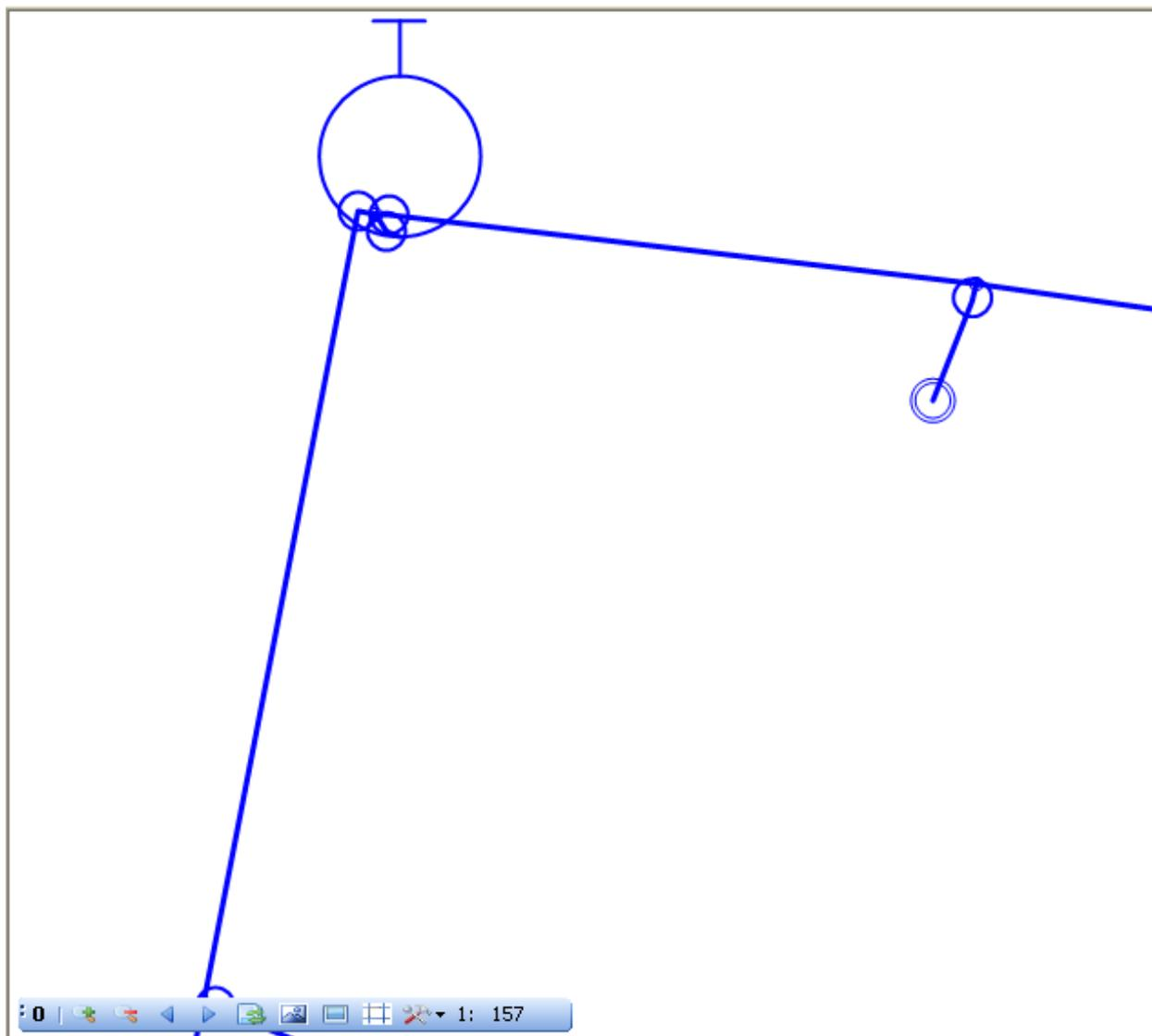
Na obrázku vidíme všechny elementy vodovodní sítě – trasu řadu, přípojek, fiktivních uzlů, uzávěrů, hydrantů a ukončení přípojek.
